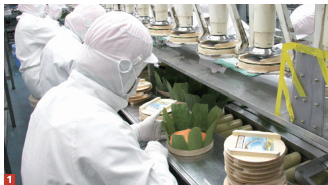
1 ますのすしの盛り付け工程。曲げ物に笹を敷き、その上にすし飯とマスの身をのせてふたを開め、押し機で圧力を加える
