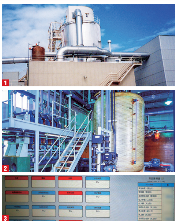
1 粉末製品を製造するためのスプレードライヤー／2 塩味を抑えるための脱塩装置。既存の食塩製造装置をアレンジして独自に開発した／3 クラフトラインのトップ画面例（一部加工）。アラートのある項目は赤く表示される。現状での問題点を総括的に把握できる
